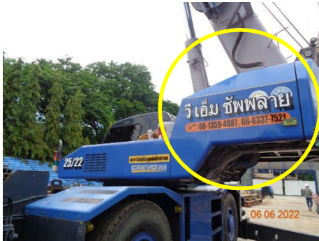
ภาพที่ 2.2-14 การปิดครอบเครื่องยนต์
